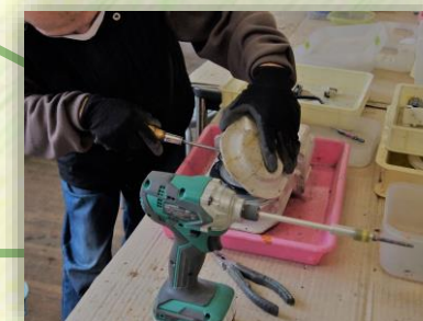
メーター解体
